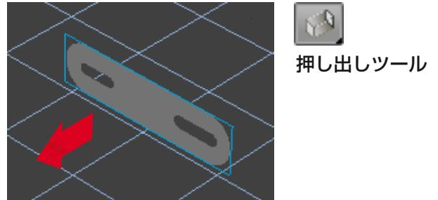
また適用されているテクスチャーを削除し、押し出しツールで厚みを与えていきます。右図のように入力端子が完成したら、非表示（常時）（**Command-3**）に設定します。
